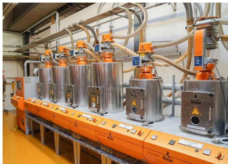
Werkstoff: Vor der Verarbeitung wird dem Kunststoff-Granulat in der Trocknungsanlage die Feuchtigkeit entzogen
