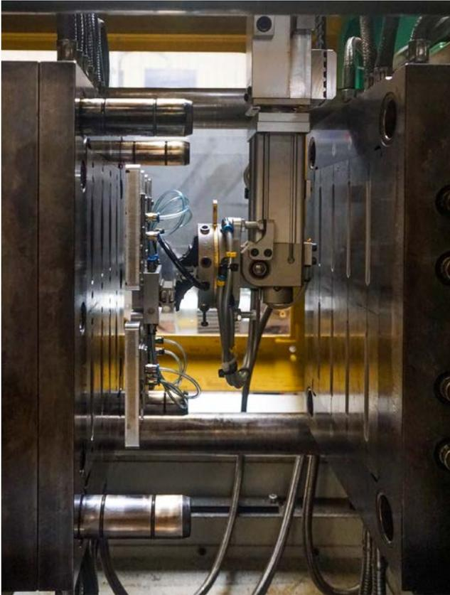
Der Kunststoff wird im Maschinentzylinder auf ca. 250 °C erhitzt und mit hohem Druck in das Werkzeug gespritzt
